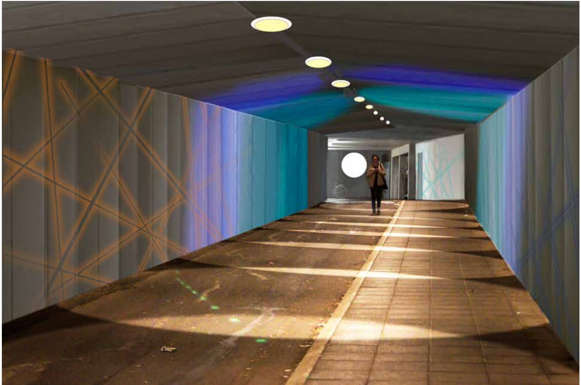
Model I - statisk. Lyset kan ikke skifte og der er ingen hvide lysporte. Færre lamper med farvet lys.
